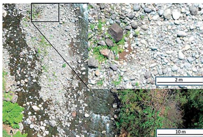
Figure 4: A) Ortho-image produit à partir de la chaîne Micmac (IGN). La résolution est de l'ordre de 6 cm . B) Image à pleine résolution de l'orthoimage et MNT de la zone correspondante. La hauteur du bloc est de 1 m environ.
