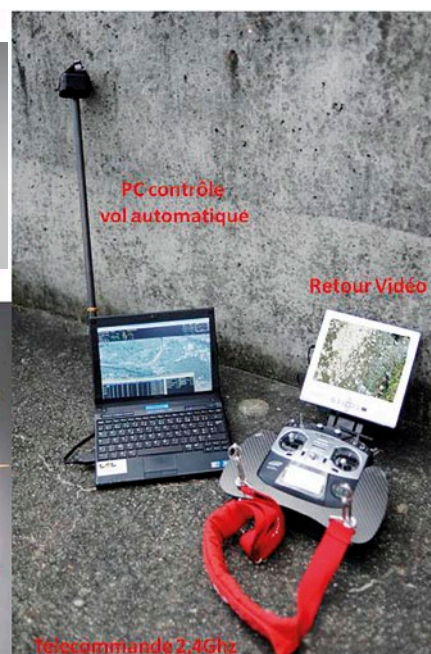
Figure 1 : Drelion, l'hélicoptère avec sa station sol (PC de contrôle de vol auto et télécommande 2.4Ghz)
